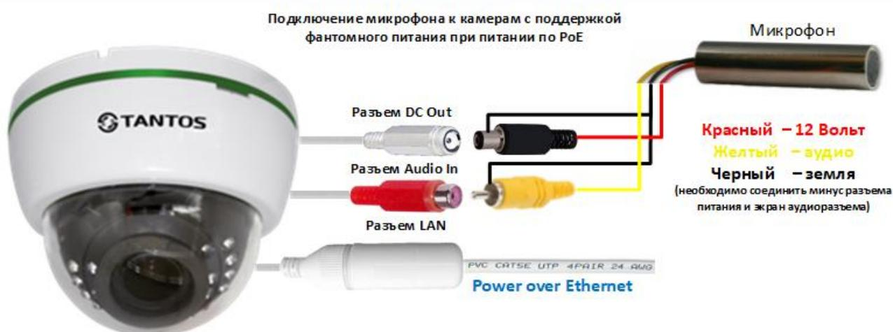
При питании таких IP-камер по PoE в самой камере вырабатывается напряжение 12В, которое подается на разъем **DC Out** камеры.
