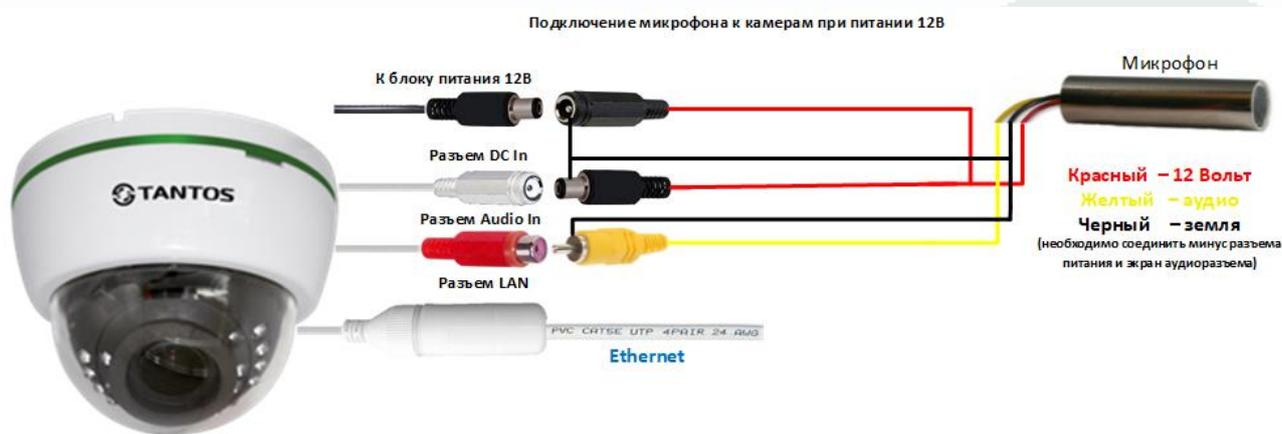
Кабель от блока питания через разветвитель подключается к камере и микрофону, аудиовыход микрофона подключается к аудиовходу камеры.
